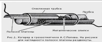
Рис. 1. Когерент в грозоотметчике А.С.Попова. На рисунке для наглядности полоски платины раздвинуты.
