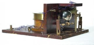
7 мая 1895 года А. С. Попов продемонстрировал возможность передачи и приема коротких и продолжительных сигналов на расстояние до 64 метров посредством электромагнитных волн с помощью специального переносного устройства, которое реагировало на электрические колебания, что стало определяющим вкладом в развитие беспроводной связи
